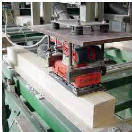
Speciální stroj na testování odolnosti brusek
